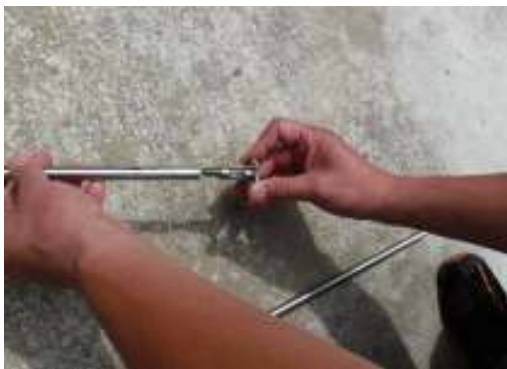
延長ロッドにカッターを取り付ける (スパナできつく締め付ける)
