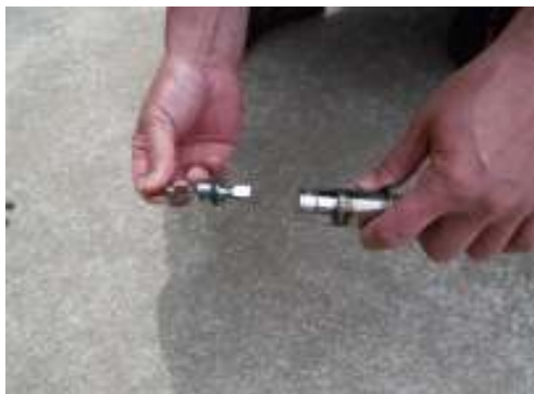
ロッドジョイントに、ユニバーサルソケットアダプターを装着する
