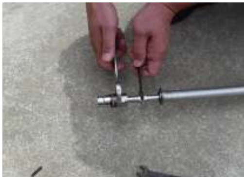
延長ロッド上部 (オスネジ側) にロッドジョイントを取り付ける (スパナできつく締め付ける)
