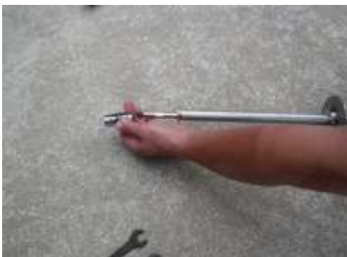
延長ロッド上部 (オスネジ側) にロッドジョイントを取り付ける (スパナできつく締め付ける)
