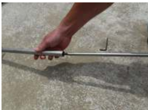
ガイド管に延長ロッドを挿入する
