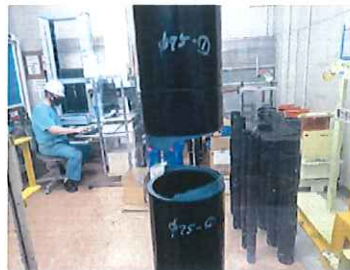
φ75 めねじ部より破断
