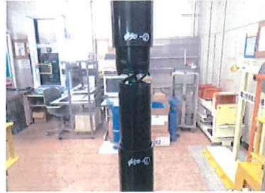
φ50 スリット部より破壊
