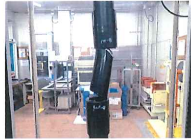
φ75 スリット部より破壊
